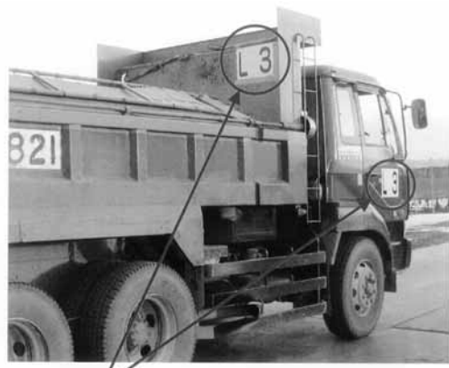
(例) L 3 背景色 : 黄色は信濃川下流築堤工事の色(信濃川下流河川事務所発注) アルファベット : 工事別の記号 数字 : ダンプトラックの管理番号
